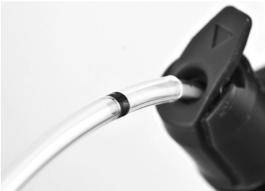
Abbildung 2: Beim CHR-CA-12.0 lässt die Sichtbarkeit der Entlastungselementmarkierung darauf schließen, dass der Katheter nicht vollständig eingeführt ist
